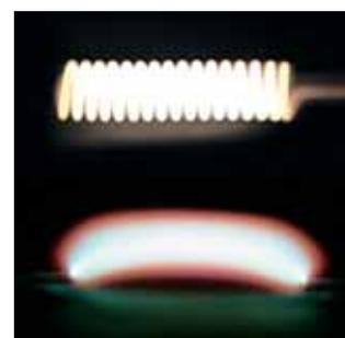
Filamento di una lampada ad alogeni confrontato all'arco di una XENARC®
