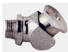
INGRASSATORE TIPO R65 FILETTO GAS. Gambo di montaggio esagonale con chiave mm. 14 testa piatta esagonale mm. 15 smontabile sul 45 gradi.
