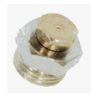
INGRASSATORE TIPO R11 Gambo di montaggio esagonale con chiave mm. 19 testa piatta esagonale mm. 15. FILETTO GAS.
